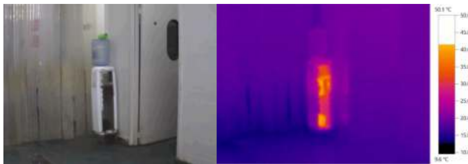
Hình 59. Phương pháp phát hiện nguồn nhiệt bằng thiết bị đo infrared
