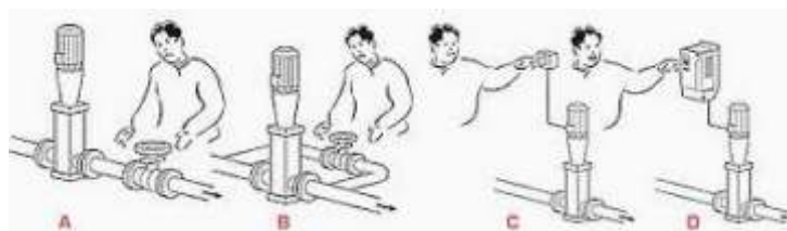
Hình 37. Các phương pháp điều khiển lưu lượng bơm
